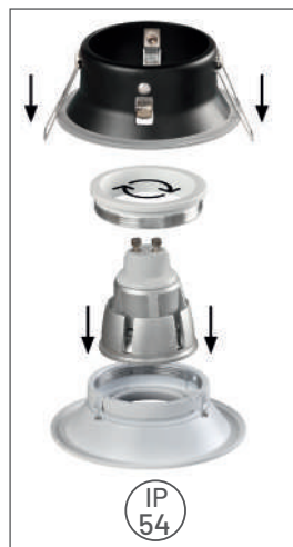
*Esquema de montaje para IP 54
