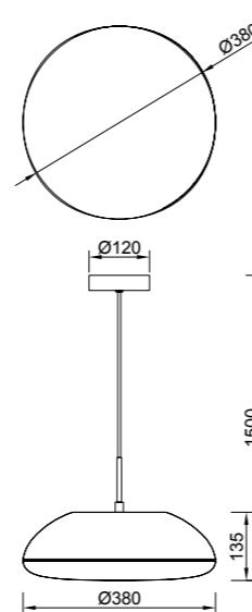
ABS/Acrílico-ABS/Acrylic 100-240V~ 50/60Hz E27 máx.20W LED
